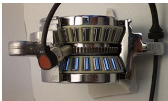
Obr. 12 ABS kroužek integrovaný v ložisku[8]
