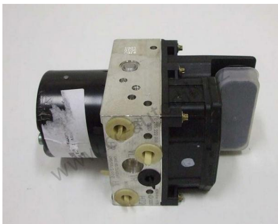
Obr. 9 Řídící jednotka ABS [7]
