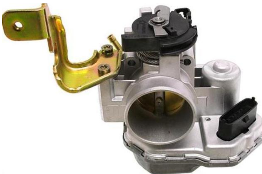
Obr. 14 Škrticí klapka Škoda Fabia [13]
