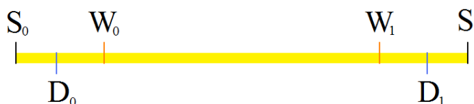
Obr. 4 Zobrazení délky dráhy, bezpečnostního a ochranného pásma v oblasti pohybu pojezdu.
