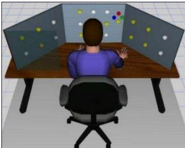
Obr. č. 9- Laboratórne meranie reakčnej doby a periférneho videnia [20]
