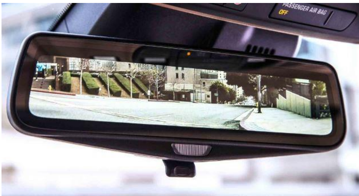
Obr. č. 6- Displej namiesto vnútorného spätného zrkadla [8]
