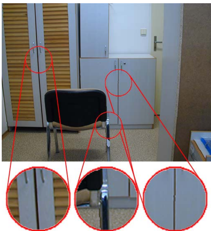
Obr. 13: Mezilehlý pohled generovaný pomocí disparitní mapy s ošetřením nežádoucího reliéfu.
