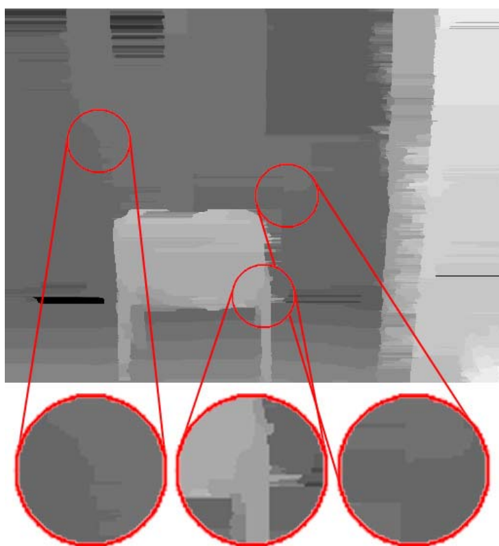
Obr. 8: Disparitní mapa získaná s ošetřením nežádoucího reliéfu.
