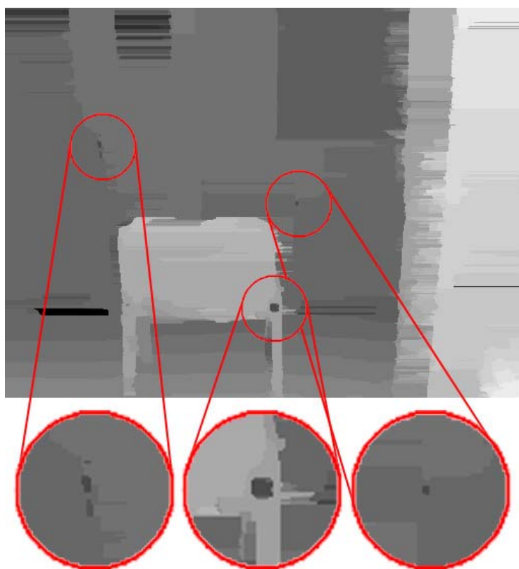
Obr. 7: Disparitní mapa získaná bez ošetření nežádoucího speciálního reliéfu.
