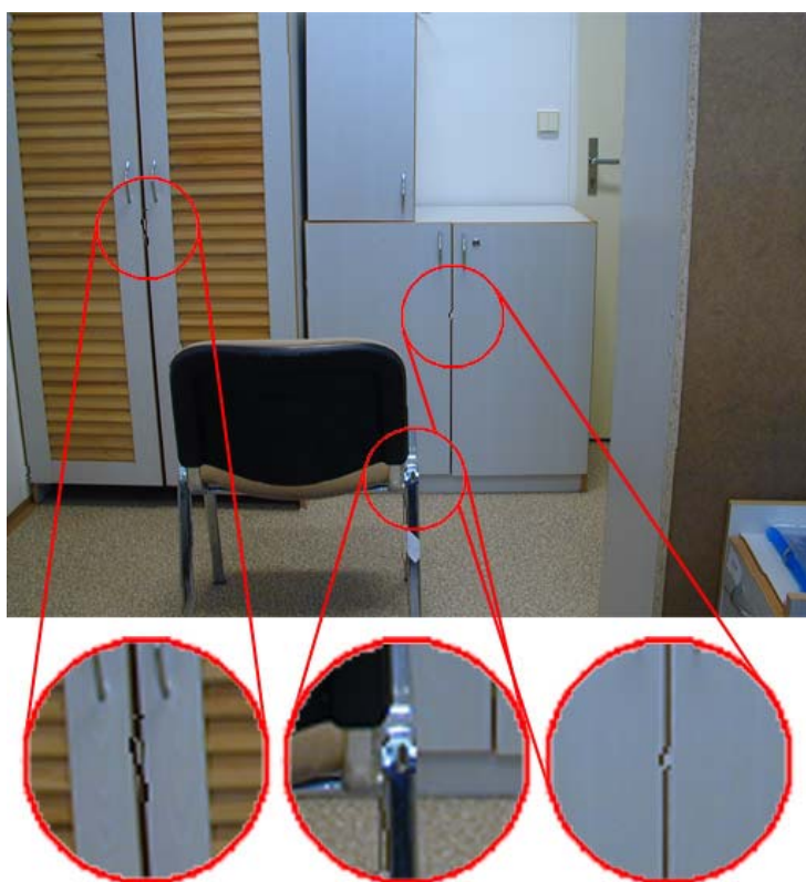
Obr. 12: Mezilehlý pohled generovaný pomocí disparitní mapy bez ošetření nežádoucího speciálního reliéfu.
