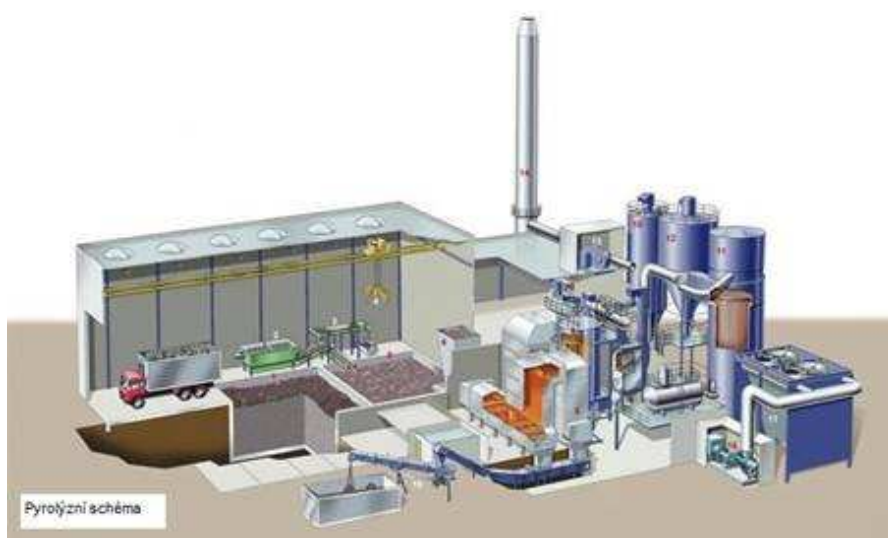
Obr. 9: Pyrolýzní schéma [13]
