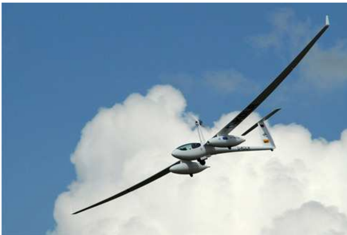
Obr. 13: Fotografie experimentálního letounu s pohonem na palivové články [14]
