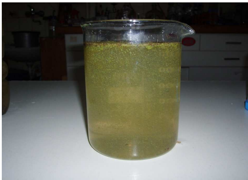
Obr. 38: Vzorek před průchodem kavitací tryskou
