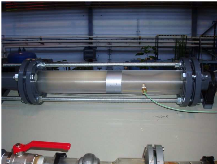
Obr. 20: Kavitační trubice
