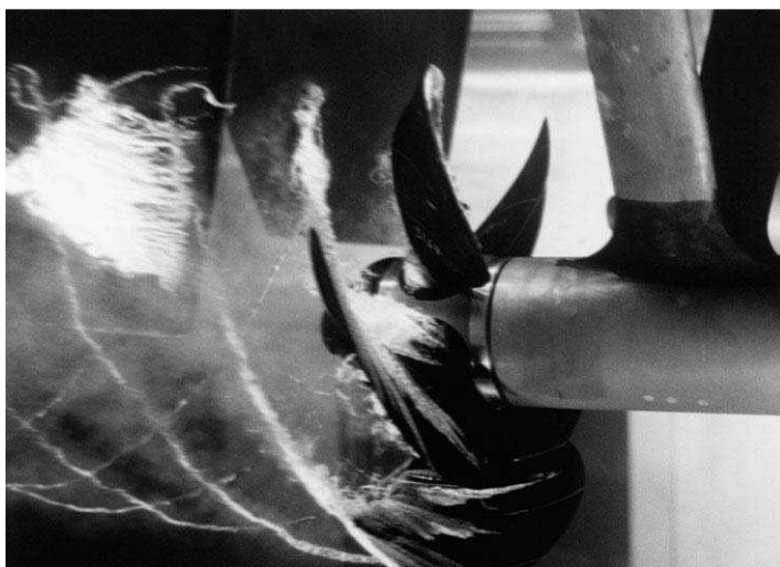
Obr. 1: Kavitace na lodním šroubu
