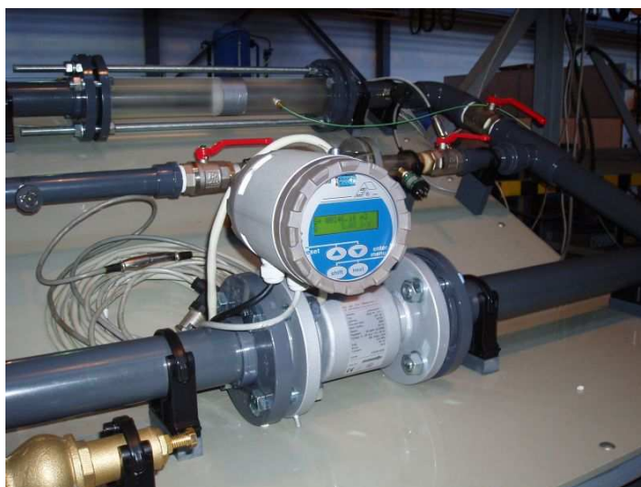
Obr. 19: Indukční průtokoměr
