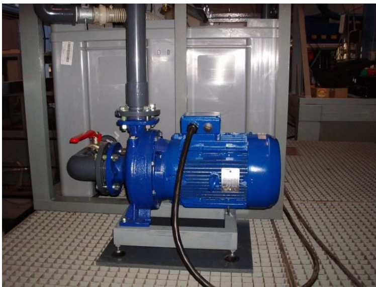
Obr. 21: Odstředivé čerpadlo
