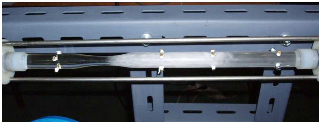
Obr. 14: Původní kavitační trubice (s plně vyvinutou kavitací)
