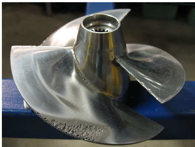
Obr. 3: Kavitační eroze povrchu materiálu
