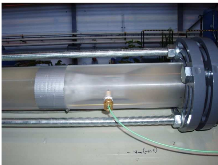
Obr. 27: Kavitace při max. Q=14,5 l/s
