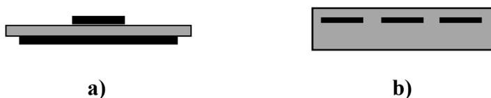
Obr. 14: Verze povrchového DBD, a) planární, b) koplanární. Černá plocha zobrazuje elektrody a šedá dielektrikum.
